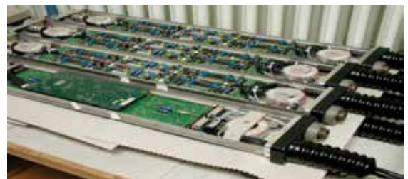
รูปที่ 16 เซนเซอร์สำหรับวัดค่าความต่างศักย์ และ กระแสไฟฟ้า
