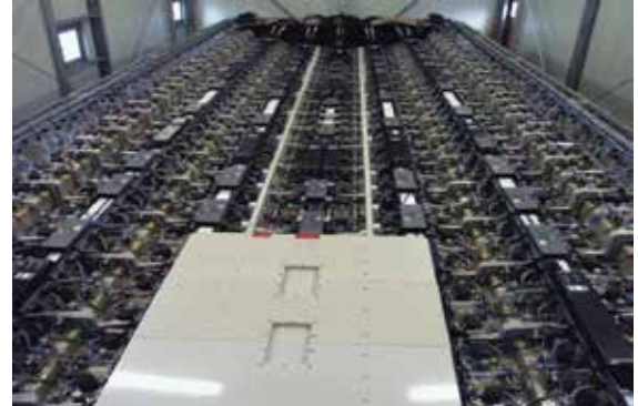
รูปที่ 3 แบตเตอรี่ในห้องเก็บแบตเตอรี่ของเรือดำน้ำ
