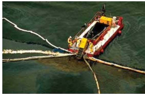
รูปที่ 3 แสดงการวางบูม (boom) จำกัดขอบเขตการแพร่กระจายของน้ำมัน
