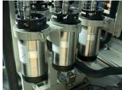
รูปที่ 20 Ion Exchanger
