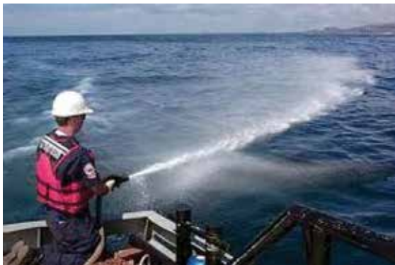
รูปที่ 1 รูปแสดงการฉีดพ่นสารเคมีขจัดคราบน้ำมันจากเรือ
