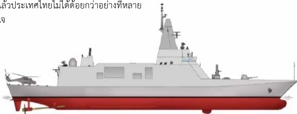
รูปที่ 4 แสดง Outboard Profile ของเรือฟริเกต
