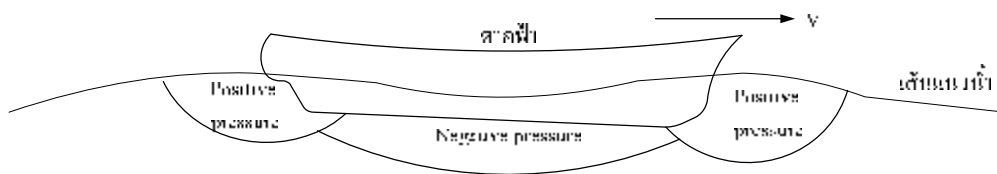
รูปที่ ๒ การกระจายของความดันใต้ตัวเรือที่กำลังเคลื่อนที่จากมุมมองด้านข้าง
