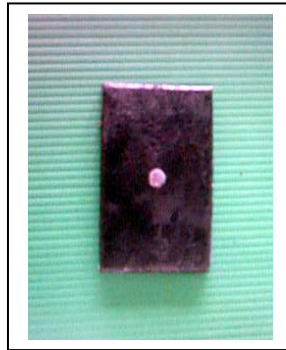
รูปที่ ๑ การเจาะฝังโลหะลงในแผ่นเหล็ก
