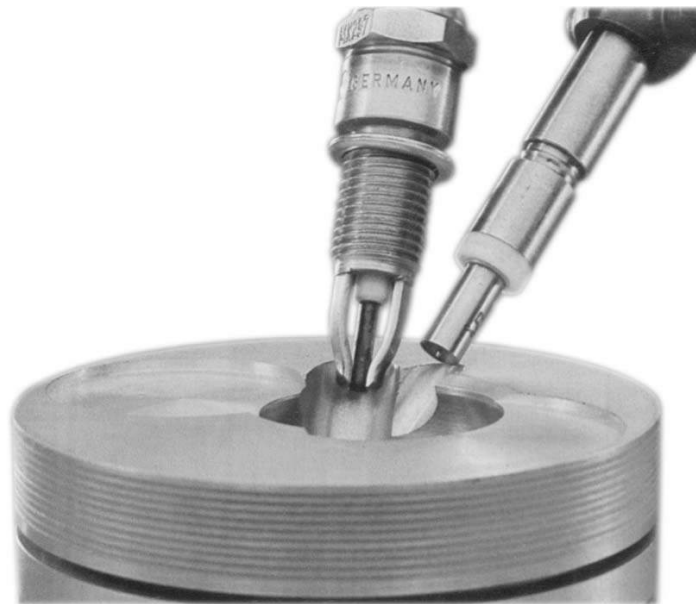
รูปที่ ๒ น้ำมันเบนซินจะถูกฉีดเข้าไปในร่องลิบบริเวณส่วนบนของลูกสูบ โดยหัวฉีดอยู่ทางขวาของหัวเทียนจุดระเบิด ในตำแหน่งที่สามารถฉีดน้ำมันเข้าไปในเปลวไฟได้โดยตรง
