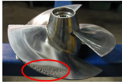
ความเสียหายที่เกิดขึ้นกับใบจักรเนื่องจาก Cavitation
